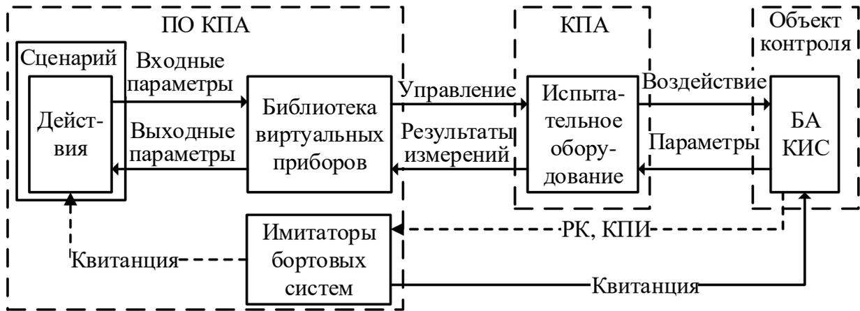
Рисунок 7 – Схема испытаний командно-программного управления
