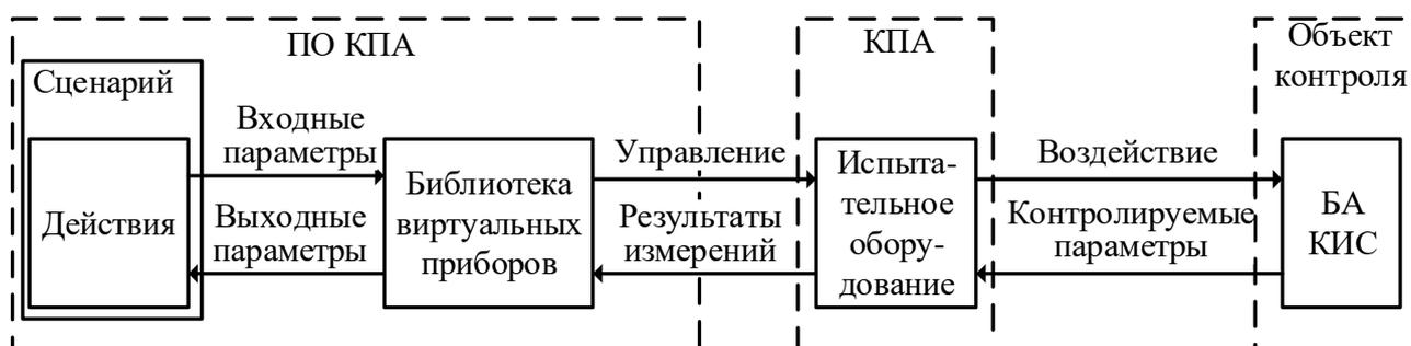
Рисунок 5 – Схема организации автономных испытаний
